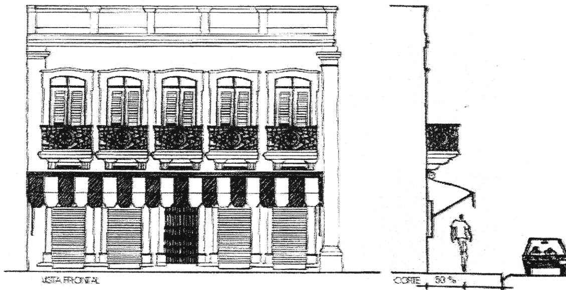
FIG. 06 – toldos no alinhamento da fachada
